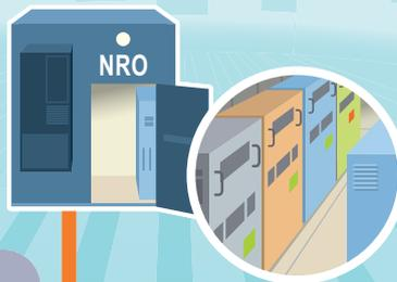
Le nœud de raccordement optique (NRO) est le point de concentration du réseau en fibre optique. Les équipements actifs à partir desquels les opérateurs activent les accès des abonnés y sont installés.
